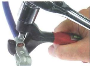
ターミナルに被覆を剥いた電線を挿入し、ラチェットレンチでボルトを締め込んでいきます。
