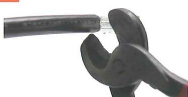
劣化したターミナルの電線と圧着された根元を切断して切断した電線の先端1cmほど被覆を剥いておきます。
