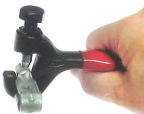
ターミナルをボルトの下に入れて挟み、ターミナルが動かないように手で軽く締め込み固定します。
