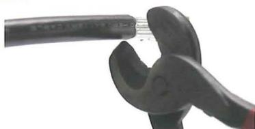
劣化したターミナルの電線と圧着された根元を切断して切断した電線の先端1cmほど被覆を剥いておきます。
