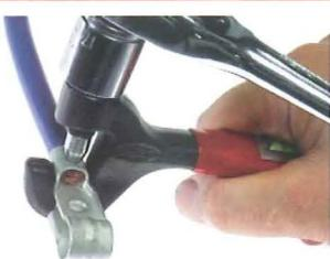
ターミナルに被覆を剥いた電線を挿入し、ラチェットレンチでボルトを締め込んでいきます。
