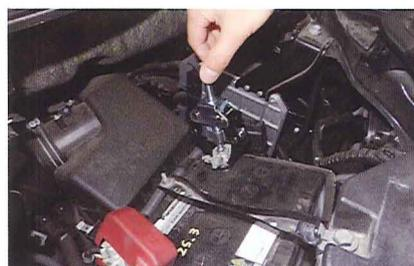
■バッテリーターミナル外し作業 ⇒専用ブローラーを使用して簡単スムーズに抜くことができます
